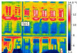
*Une façade d'un immeuble dans le 1<sup>er</sup>, vue à la caméra thermique, où se voient les pertes de chaleur. Une isolation extérieure pourrait être faite par un enduit isolant, comme cela a été fait sur la façade en photo ci-dessous.*
